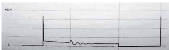
Figura 3: Gráfico do circuito primário de ignição eletrônico (inferior) [V(t)] (Fonte: SCHOMMER e XAVIER, 2006, p.50)
